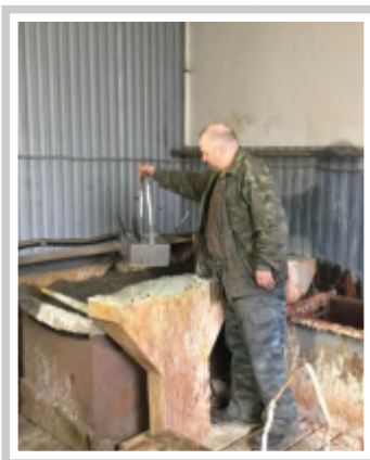
Процесс покрытия деталей тонким слоем металла путем электролиза в гальванических ваннах
