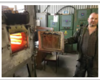
Печи камерного и шахтного типа, на которых выполняются все виды термообработки
