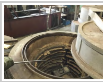
Печи камерного и шахтного типа, на которых выполняются все виды термообработки
